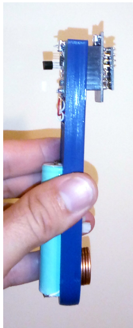
Vnitřek iSpindelu po sestavení. Všimněte si přilepených mincí jako závaží na pravé straně.
