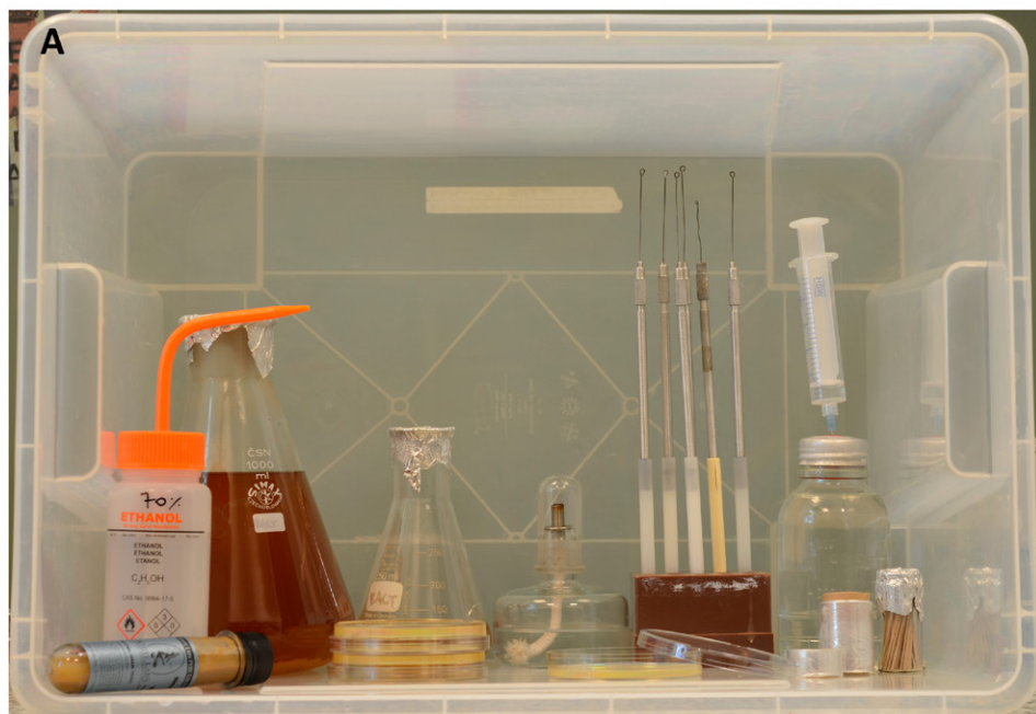
Obrázek 1 (A) – Pomůcky pro kultivaci kvasnic umístěné v plastové krabici (zleva): WLP zkumavka (měřítka pro představu), nádoba (stříčka) na ethanol, Erlenmeyerovy baňky (1L a 250ml), Petriho misky, lihový kahan, očkovací kličky, sterilní fyziologický roztok, stříkačka s jehlou, potravinová folie (k omotání Petriho misek) a zkumavka se sterilními párátky. (B) – Tlakový hrnec – Erlenmeyerovy baňky uzavřené alobalem, umístěné na napařovací mřížce v tlakovém hrnci.
